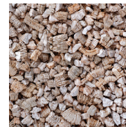
isolamento de sótão em vermiculite
